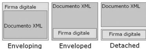
Figura 3.13: I tre tipi di firma previsti in Java per i documenti XML: Enveloped, Enveloping e Detached
